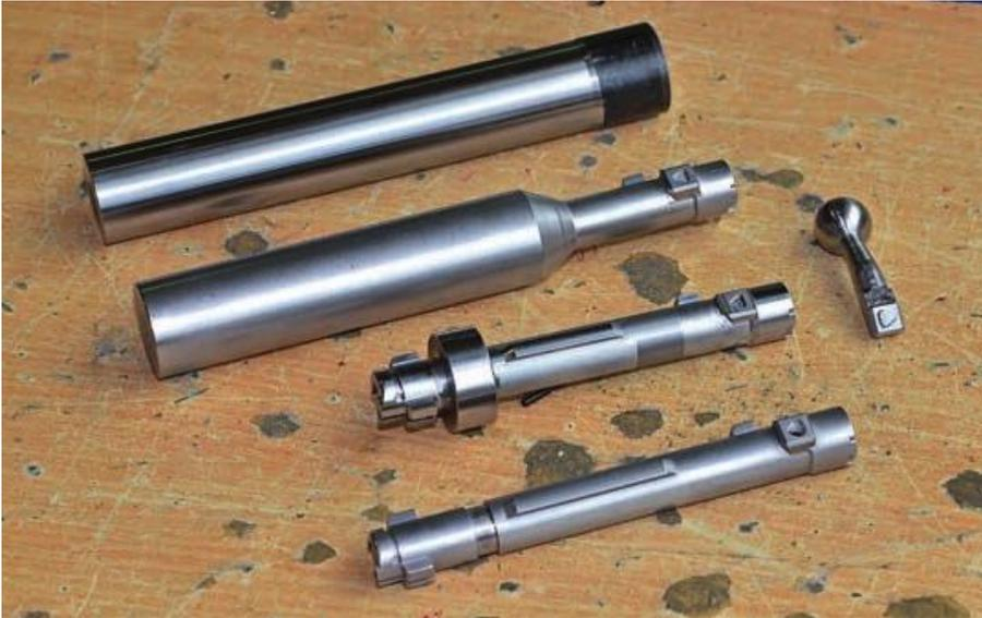
**Entstehung einer Verschlusskammer (von hinten nach vorne):** Rohteil, erste Bearbeitungsstufe mit dritter Warze und Fläche für den Kammerstängel, zweite Bearbeitungsstufe mit Führungsnuten und Verriegelungswarzen sowie das Fertigteil.
